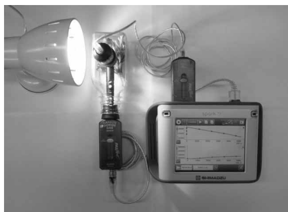
図 1。 SPARK データロガー。左図は、植物の葉を入れた透明容器に酸素センサと二酸化炭素センサを取り付け、LED 電灯を照射している様子。右図は、ドクダミの葉 (5 g) を用いて行った測定結果の一例を示す。
